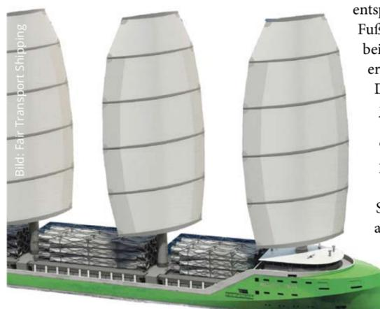
entwickelten die einstigen Konkurrenten der Handelsschiffahrt Hapag-Lloyd/CSAV und Hyundai Merchant Marine eine völlig neue Ecoliner Generation namens DEM als Mischform der Schiffstypen Dynaship und Emma Mærsk. Ausgestattet mit einem dynamischen
